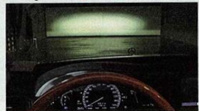
Volles Fernlicht, die 96 LED im Mercedes-Scheinwerfer leuchten bis zu 300 Meter weit
