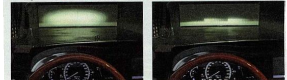
Volles Fernlicht, die 96 LED im Mercedes-Scheinwerfer leuchten bis zu 300 Meter weit
