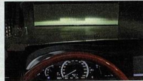
Typische Abblendlicht-Verteilung, die beim Prototyp noch einzelne Pixel zeigt
