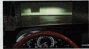
Eine Kamera erkennt entgegenkommende Autos, die durch Abschalten einzelner LED aus dem Lichtkegel ausgeblendet werden
