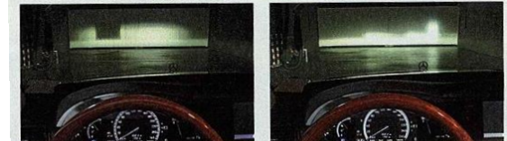
Eine Kamera erkennt entgegenkommende Autos, die durch Abschalten einzelner LED aus dem Lichtkegel ausgeblendet werden
