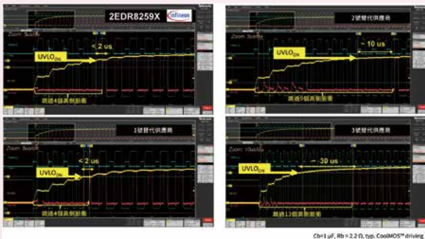
圖2：最先進的雙通道隔離式閘極驅動器IC的UVLO啟動時間比較。
