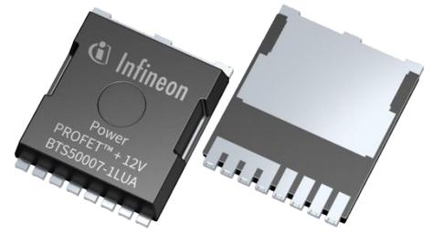
新しいPower PROFET™ + 12Vスマート ハイサイドスイッチ ファミリーの最新製品は、8ピンの小型リードレスパワーパッケージで、0.7 mΩという非常に低い $R_{DS(on)}$ を実現しています。Power PROFET™ + 12Vは、最大55 Aの大電流負荷を駆動する能力、最先端の保護機能および診断機能を内蔵しており、12 Vボードネットの電源配電システムやその他の大電流アプリケーションにおける電気機械式リレーやヒューズ、ディスクリート回路の置き換えに最適です。
