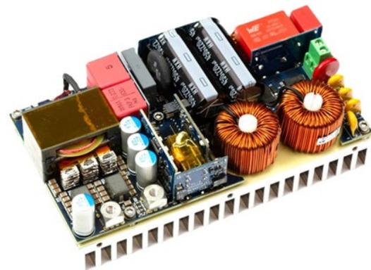
本PSUは、フロントエンドのAC-DCブリッジレス・トータムポールPFCコンバーターと、それに続くバックエンドのDC-DC絶縁型ハーフブリッジ (HB) LLCコンバーターで構成されています。フロントエンドのコンバーターは力率改善 (PFC) と全高調波歪み (THD) を提供します。LLC コンバーターは安全絶縁を提供し、出力電圧は 12 V<sub>DC</sub> で厳密に提供されます。
