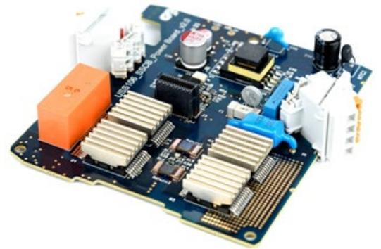
REF\_SSCB\_AC\_DC\_1PH\_16Aソリッドステート サーキットブレーカー (SSCB) キットを使用すると、インタラクティブなGUIでAC/DCタイプのサーキットブレーカーを迅速に評価できます。2つの基板を搭載したフル機能の本キットは、AC230 VもしくはDC350 V動作と公称電流16 Aに対応します。1P-N、3P-N (スタック型、カスケード型)、L+ - L-など、異なるSSCBトポロジーに対応します。非絶縁型冷却器を上面放熱(TSC) MOSFETパッケージ上に搭載した受動冷却をサポートします。
