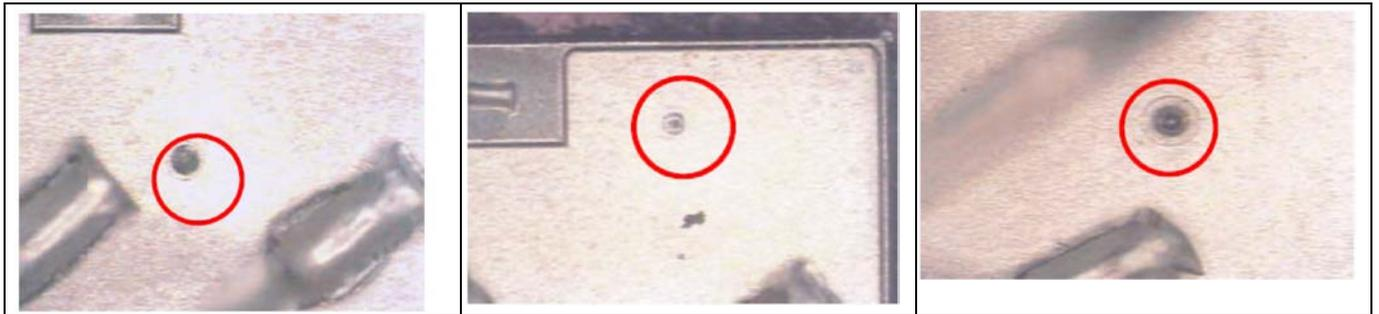
Figure 7 パワーMOSFET のランダム デバイス障害スポットの例
