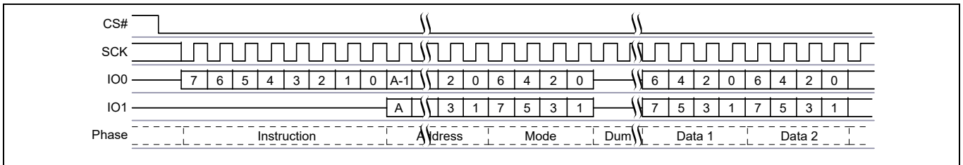
Figure 69 デュアル I/O 読み出しコマンド シーケンス [32, 33]
